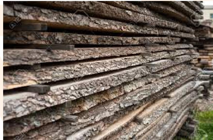
La normativa ISPM-15 ammette la presenza di corteccia residua di dimensioni inferiori a 3 cm di larghezza o, se più larga, di lunghezza inferiore a 50 cm.
